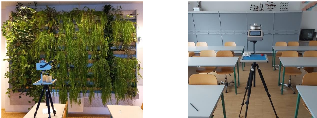
Abbildung 2: Luftkeimsammler in einer begrünt (links) bzw. nicht begrüntem Klasse (rechts)
