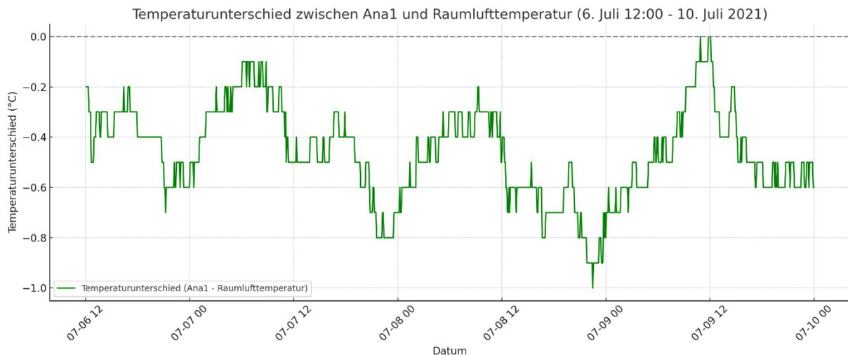
**Abbildung 33: Temperaturunterschied zwischen Estrich- und Raumtemperatur**
