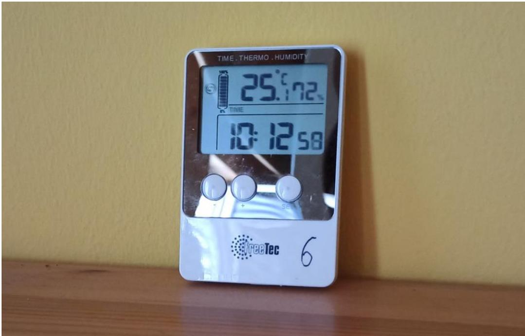
**Abbildung 1: Datalogger von FreeTec zur Messung von Temperatur und rel. Luftfeuchtigkeit**
