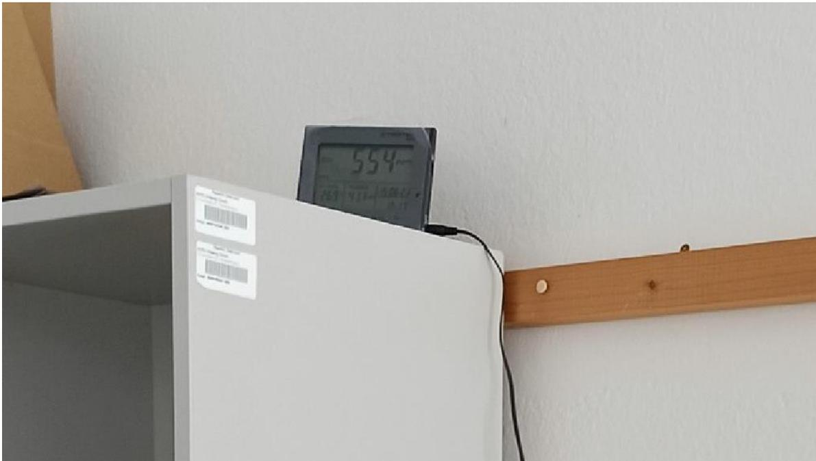
**Abbildung 2: CO<sub>2</sub> Datalogger der Firma Trotec bei einer Messkampagne im BORG**
