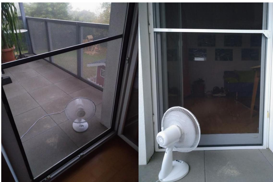
**Abbildung 27: Low-Tech-Ansatz mit Ventilator um bei einer fehlenden Querluftströmung in der Wohnung dennoch ausreichend Luftwechselrate zu erzeugen, um in der Nacht die Räume abzukühlen**
