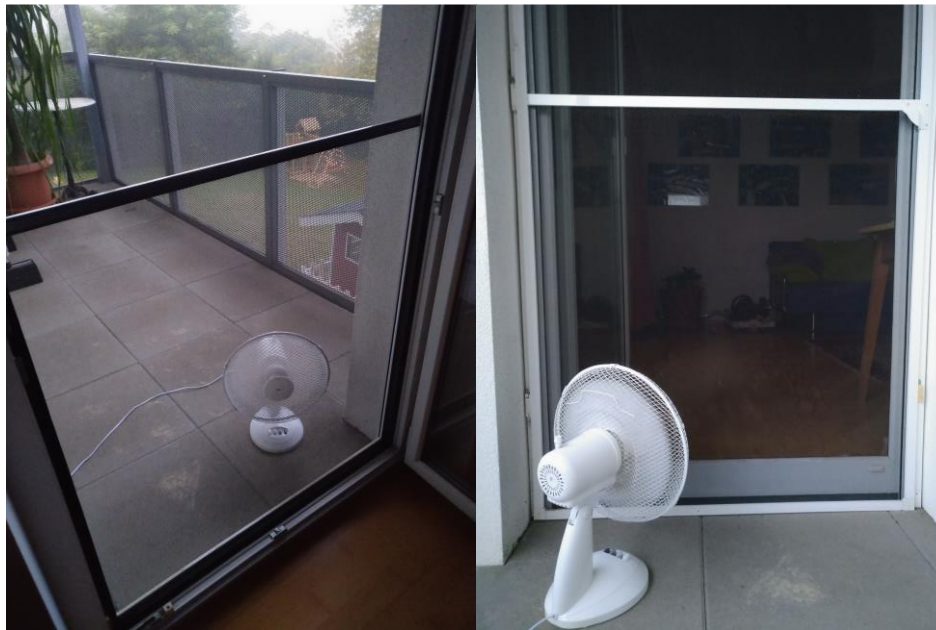
Abbildung 22: Low-Tech-Ansatz mit Ventilator um bei einer fehlenden Querluftströmung in der Wohnung dennoch ausreichend Luftwechselrate zu erzeugen, um in der Nacht die Räume abzukühlen
