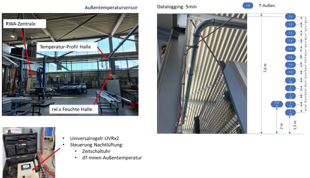
Abbildung 23: Messaufbau Temperaturprofil, Verteilung der Sensoren
