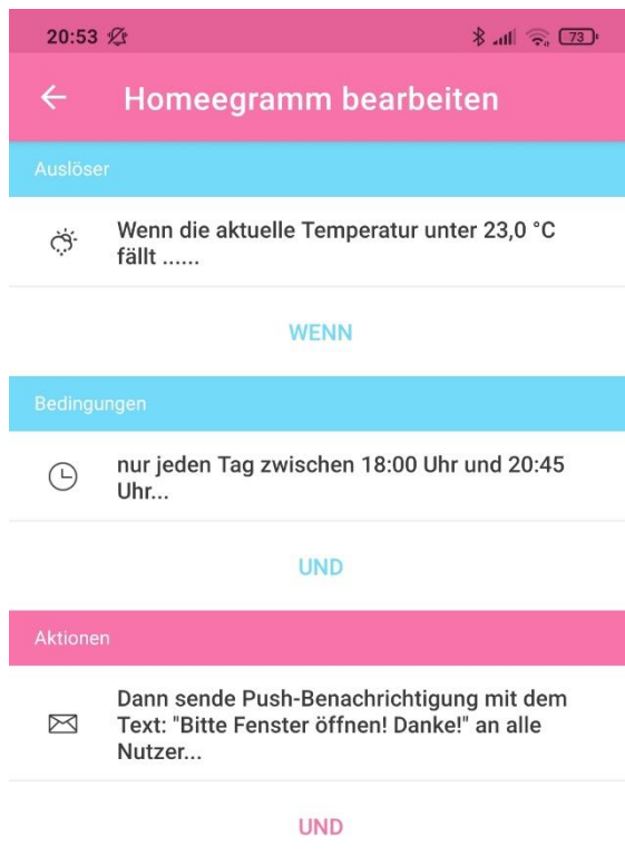
Abbildung 15: Einstellung der Push-Nachricht zum Öffnen der Fenster via homee
