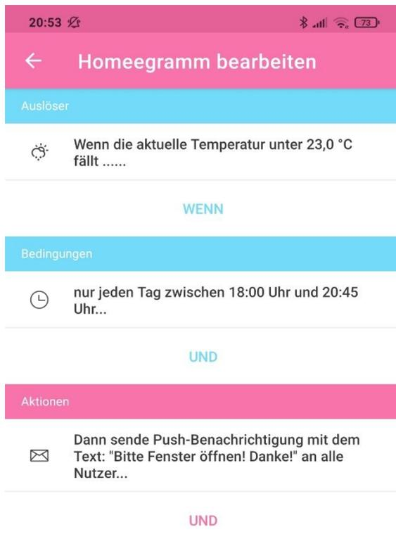
Abbildung 41: Einstellung der Push-Nachricht zum Öffnen der Fenster via homee
