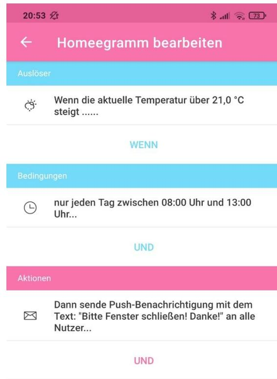
Abbildung 42: Einstellung der Push-Nachricht zum Schließen der Fenster via homee
