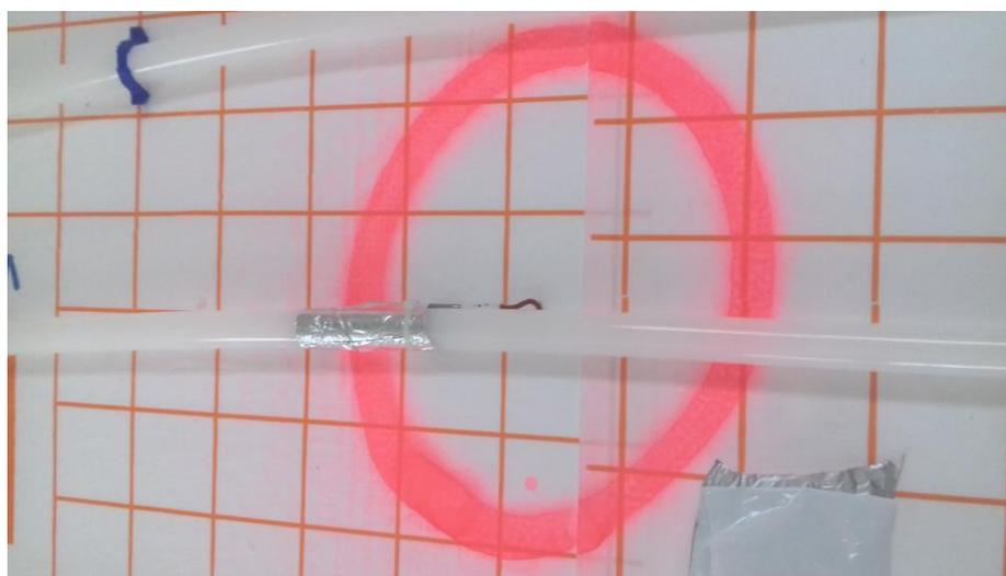
**Abbildung 58: Temperatursensor am Rohr der Fußbodenheizung montiert**
