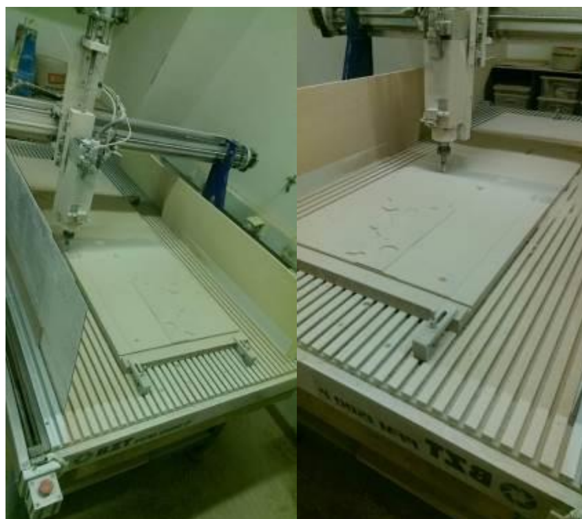
Abbildung 35: Geländeausarbeitung mittels CNC-Fräse
