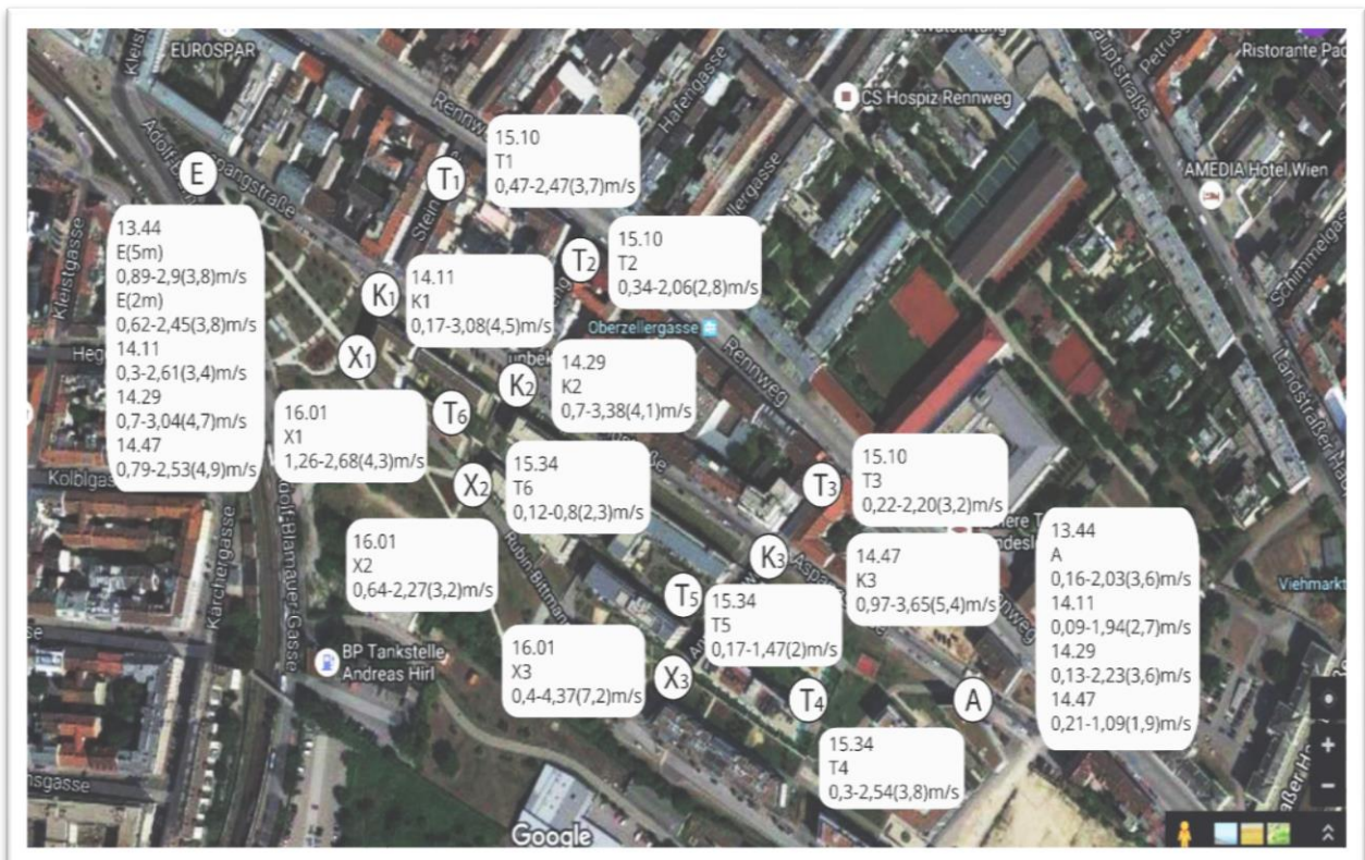
Abbildung 79: Windgeschwindigkeit (in m/s) bei den Vor-Ort Messungen während der Bestandsaufnahme im Zeitraum von 13:44 bis 16:01 Uhr Q: Google Maps 2017, eigene Überarbeitung
