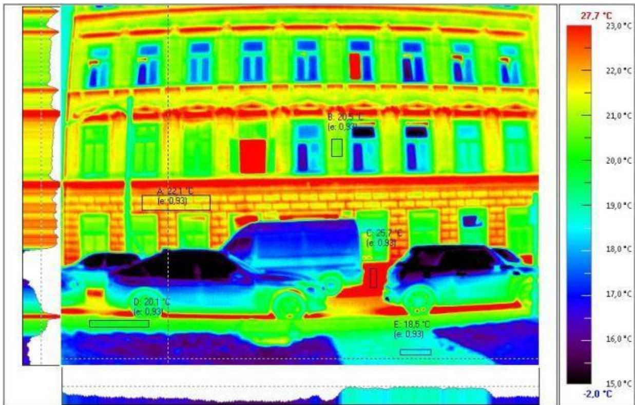
Abbildung 45: Oberflächentemperatur des Sockelbereichs und des Asphalts vor dem Gründerzeithaus, Aspangstraße 31
