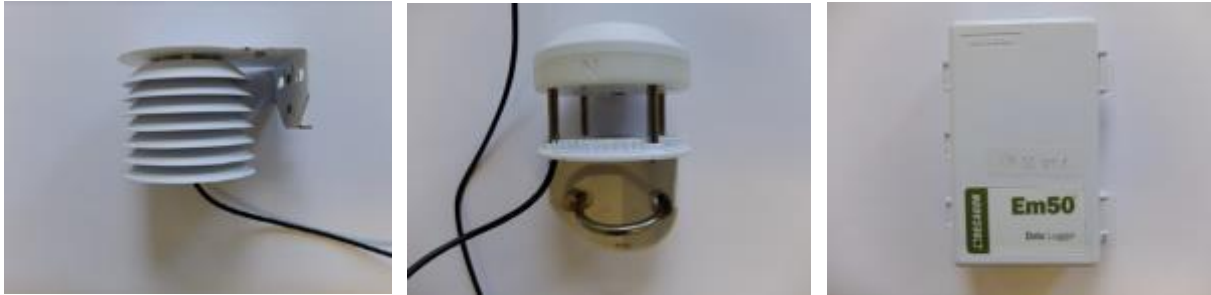
Abbildung 22: Eingesetzte Sensortechnik von links nach rechts: DS-2 Sonic Anemometer, VP-4 Luftfeuchte,
