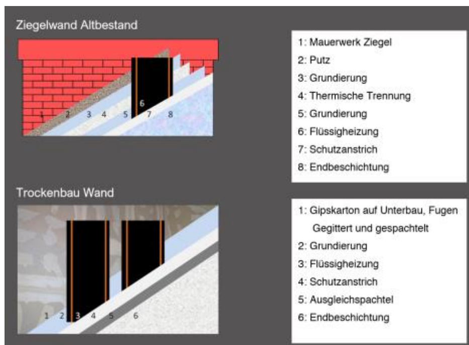
Abb. 76: Benötigter Wandaufbau der Flüssigheizung 134
