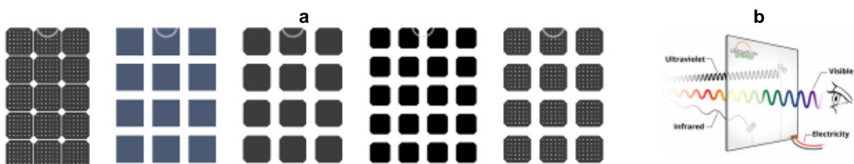
Abb. 12: (a) Verschiedene transluzente Solarmodule 34 ; (b) Absorption von Ultraviolett- und Infrarotstrahlung 35
