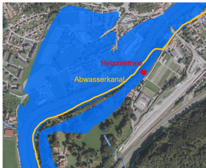
Abbildung 38: Lage von Abwasserkanal & Heizzentrale im HQ-30 Abflussbereich der Mur 29
