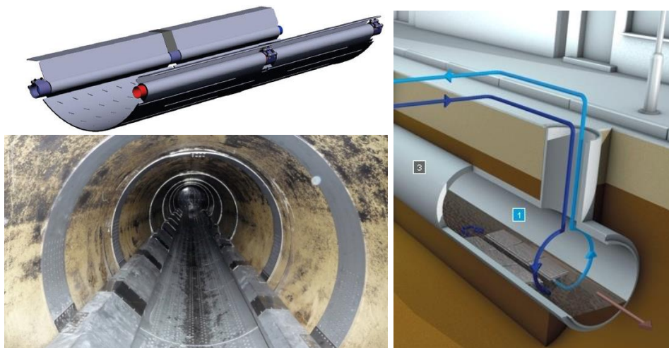
Abbildung 13: Kanalwärmetersysteme zur Abwasserwärmenutzung in Bestandskanälen Therm-Liner (Uhrig Kanaltechnik GmbH) und TubeWin (Huber SE) 13 14 15
