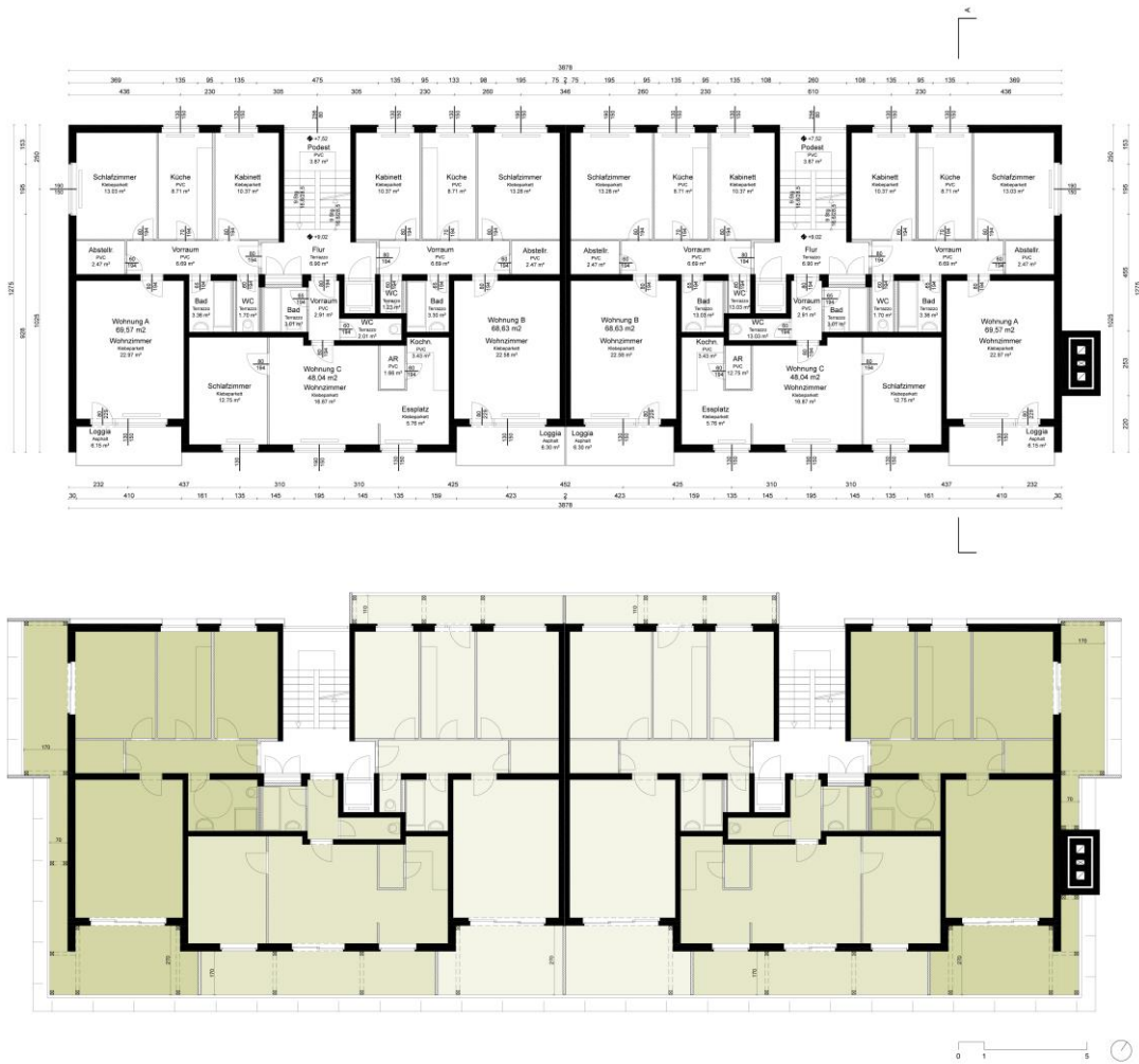
Abb. 64: Studie zur Übertragbarkeit der STELA-Methode. Längsgerichteter Baukörper mit Nord-Süd Orientierung. Bestand (oben), Sanierung (Mitte) Ausschnitt Fassade / Konstruktion (unten)
