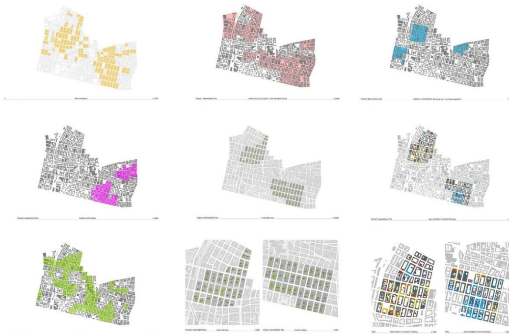
Abb. 29: Exemplarische Darstellung verschiedener Karten des ausgewählten Betrachtungsgebiets mit der Darstellung der verschiedenen stadträumlichen Kriterien zur Einschätzung von Umsetzungspotenzialen entlang der Stadtentwicklungsstrategie PMO. Zeilenweise von links nach rechts: Katasteranalyse, Sanierungszielgebiete, Stadtentwicklungsgebiete, Energiepotenziale, Innenhofanalyse - wie darunter, Nachverdichtungspotenzial - wie darunter, Grünraumbedarf
